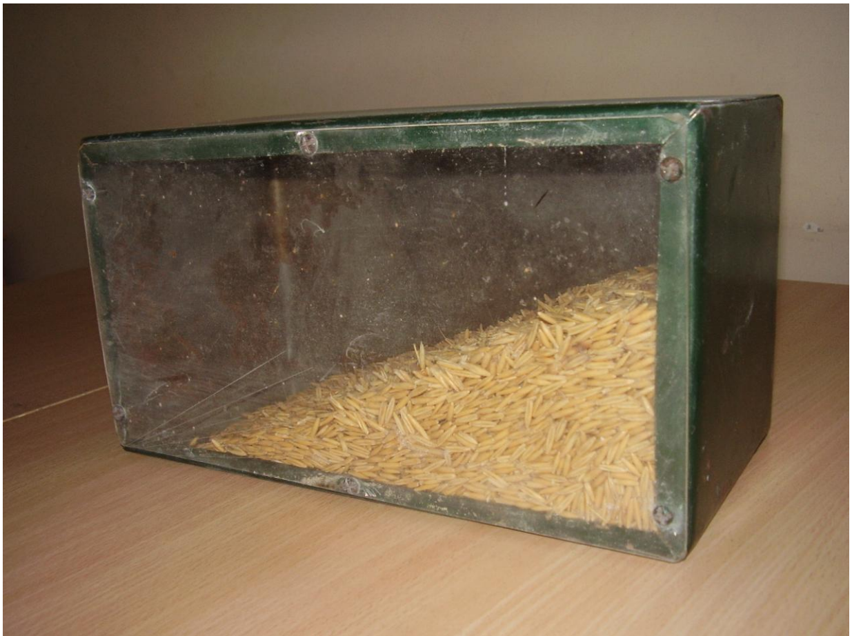
Рис. 2.1. Прозрачный сосуд для определения угла естественного откоса
